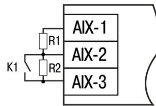
Рисунок 10 – Схема подключения датчика типа «сухой контакт»
