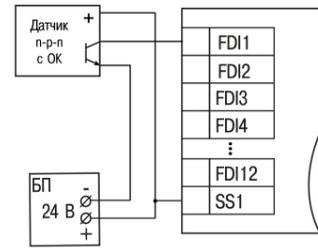
Рисунок 13 – Подключение транзисторов типа п-р-п\*
