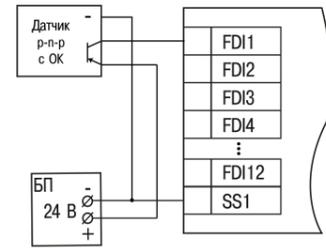
Рисунок 12 – Подключение транзисторов типа р-п-р
