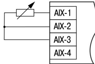
Рисунок 9 – Схема подключения датчиков типа 0...2 кОм и 0...5 кОм
