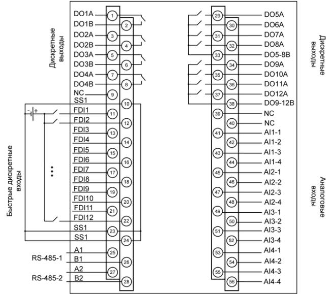
Рисунок 3 – Назначение контактов клеммника
