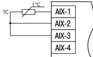
Рисунок 4 – Схема подключения TC по трехпроводной схеме
